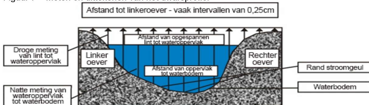
Figuur 7 – Meten en uittekenen van het dwarsprofiel
